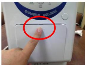
以上で、ロール及び水タンクのセットは終了です。使用前に取り出し口上部「PUSH」と表示のある部分を押し、取り出し口を開いて下さい。
