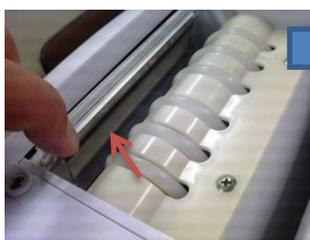
③ロール押さえ部材を指で押し上げ、そこにロールの端を送りこみます。ロールの端がシルバーのローラー部分まで到達すれば、ロール押さえ部材を元に戻し、ロールを挟み込みます。
